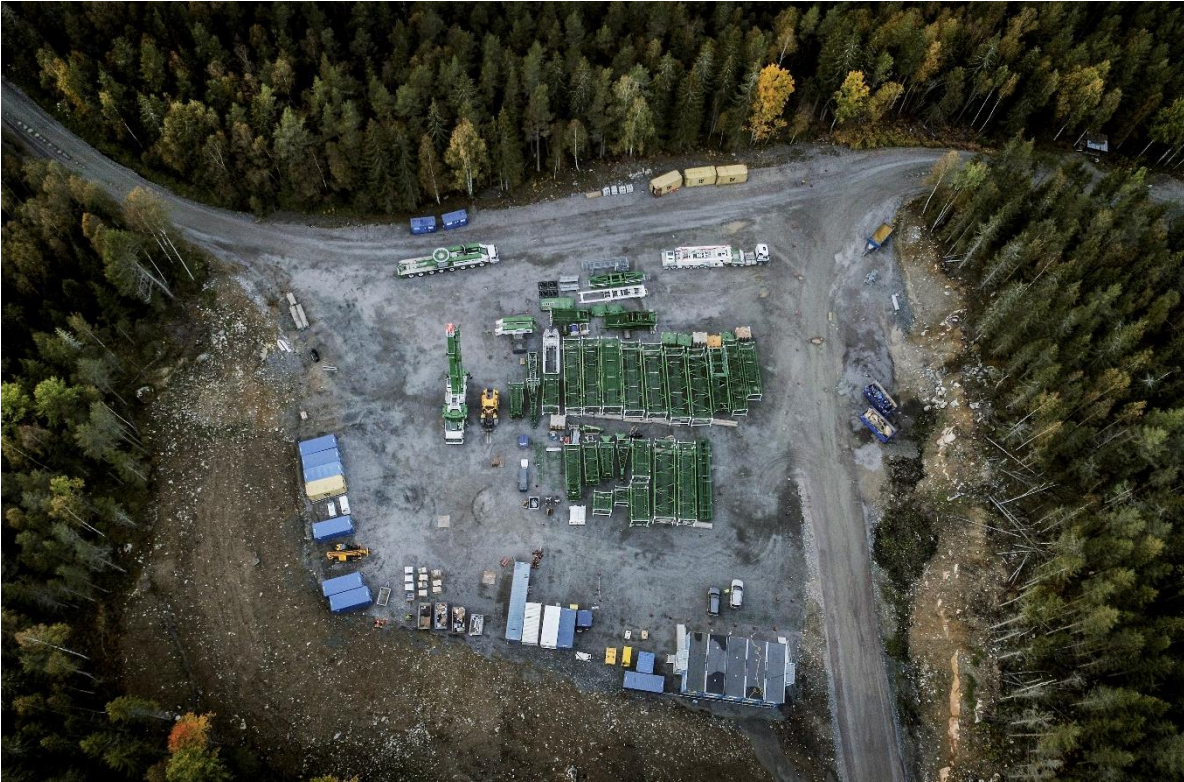
Figur 20 Foto exempel på logistikyta vid byggnation av Vindpark Kronoberget. Källa SR Energy AB.
