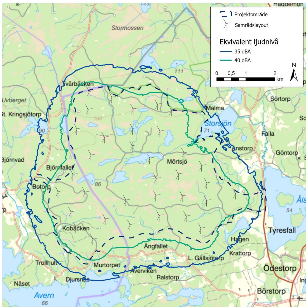
Figur 12. Ljudberäkning för exempellayout med 34 vindkraftverk med 270 m totalhöjd.
