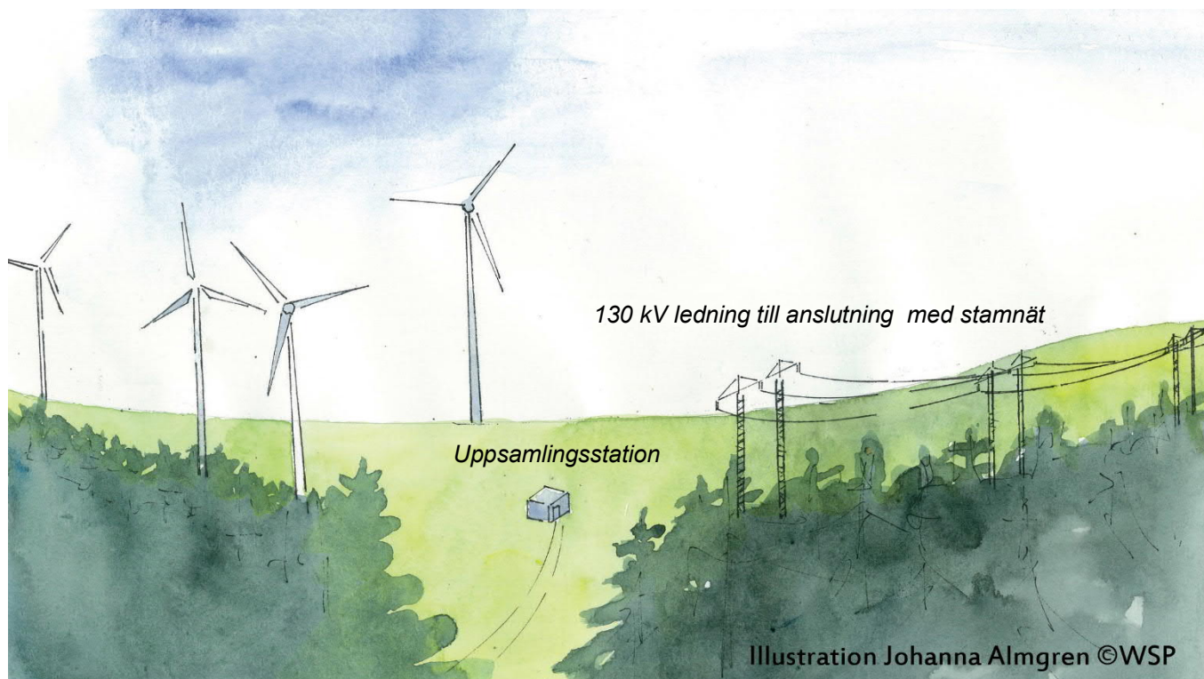
Figur 10. Elenergin leds via ett kabelnät via uppsamlingsstationen till överliggande stamnät
