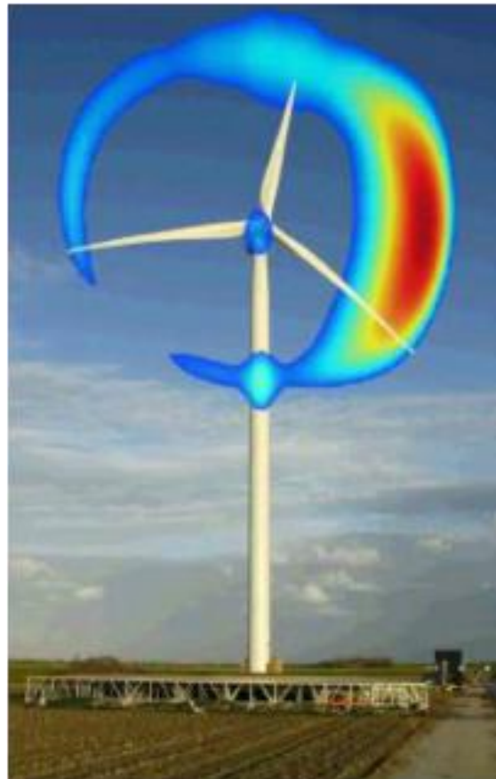
Figur 2 Ljudalstring från ett vindkraftverk, visualiserad genom mätning med akustisk kamera. Utdrag från Lindkvist 2010.
